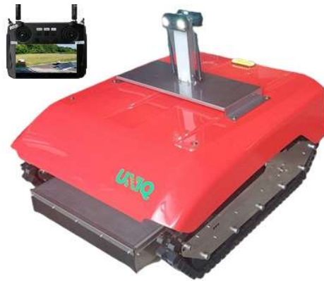
写真1 遠隔操作ユニット付きオール電動草刈ロボット「ユニモワーズ model-S」
